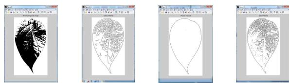
a. Otsu b. Canny c. Prewitt d. Sobel
